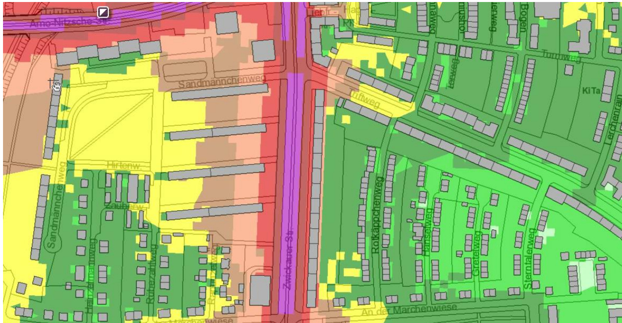
Beispiel Zwickauer Straße in Leipzig/Marienbrunn: Rechts schützt der geschlossene Blockrand den Innenhof und das Siedlungsgebiet in der ‚zweiten Reihe‘. Auf der linken Straßenseite kann sich der Verkehrslärm aufgrund der losen Zeilenbauweise nahezu ungehindert ausbreiten. (Bild: Screenshot Online-Lärmkarte auf www.leipzig.de )
